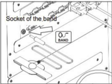
Collegare la banda o la lastra alla presa sul retro del dispositivo.
