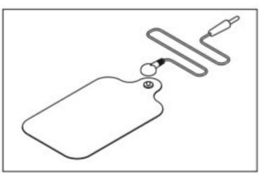
Per collegare la lastra metallica è necessario staccare la clip del cavo dalla banda per fissarla alla superficie metallica.
